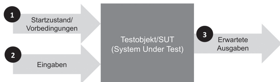
Abb. 1: Genereller Aufbau eines Testfalls.
